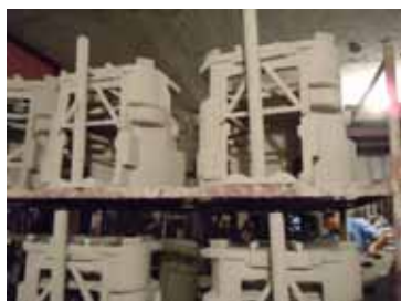
図 43 塗型乾燥（変形防止用棧 （発泡材）は本体と一体 成型されている）
