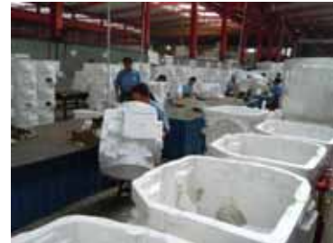
図 39 発泡樹脂模型組み立 てステージ
