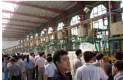
図 38 発泡樹脂模型成形機（縦型） ライン（鑄物換算 4 万 t / 年 能力）
