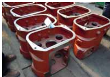
図 44 いずれも上部加工面には ザク巣が確認された （トラックミッショナース）
