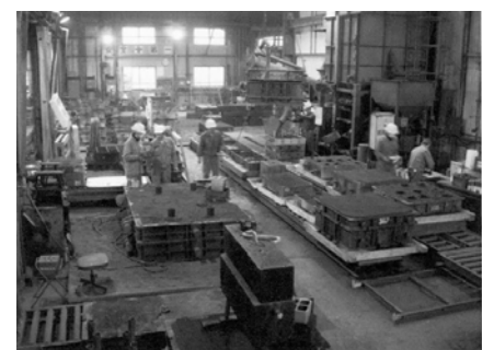
図5 振動テーブルを用いたFM造型現場 (静岡 梅沢鑄工(株))
