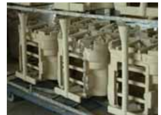
図48 塗型乾燥(鑄物は華恩と同じも、湯道方案・変形防止法が異なる)
