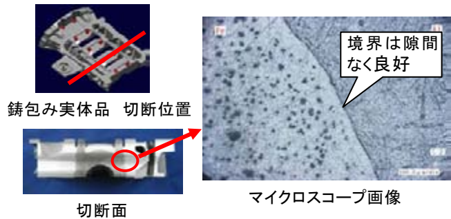
図 1-2 木型での実体品鋳包み状況
