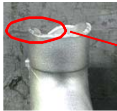
(a)先端部の湯回り不良
