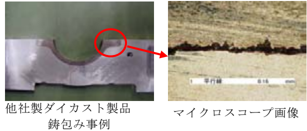
図 1-1 アルミダイカスト製の鋳包み
