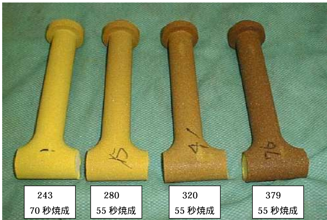
図10 テストピースの色と金型温度（フラタリーRCS）
