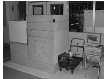
図 2.1-2 2 回屈曲構造を有する試験体
