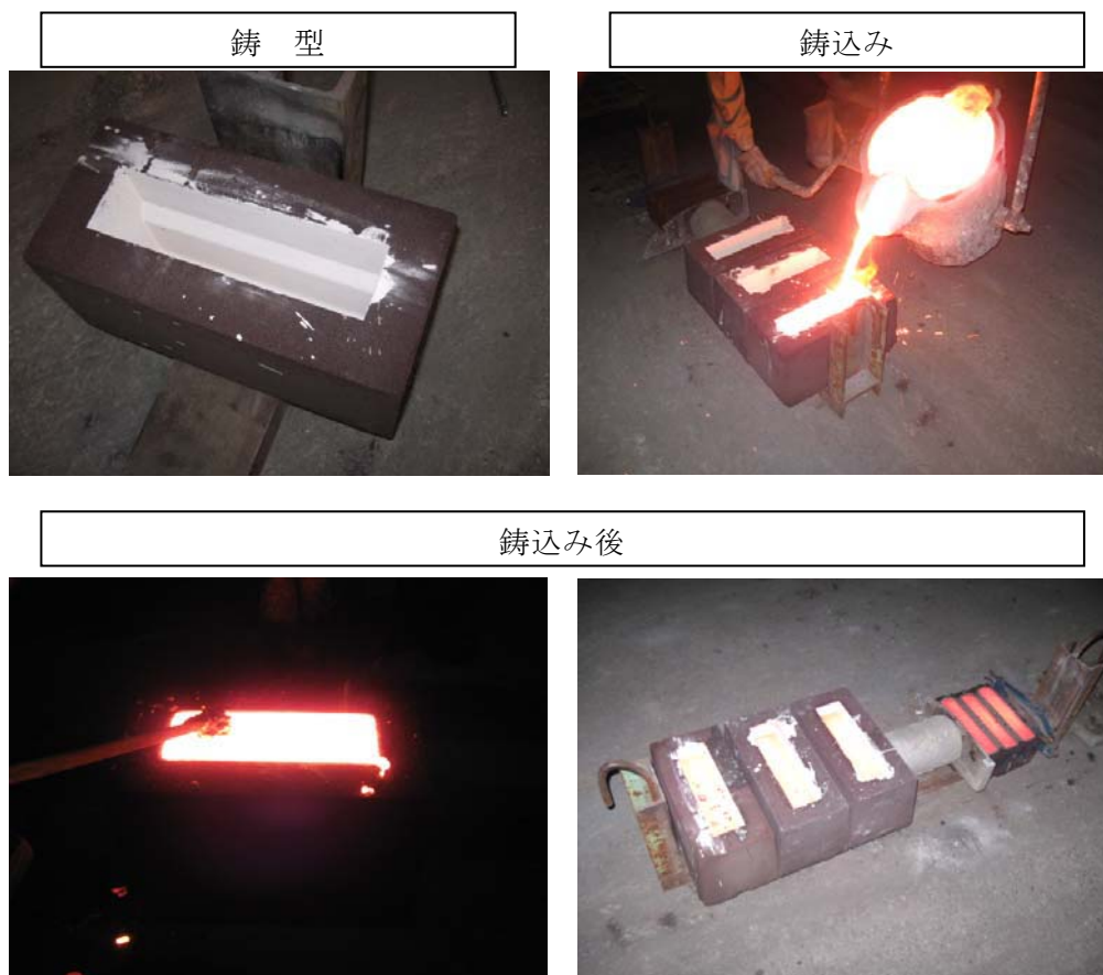
図表 40 試験片・供試材の鑄込み作業
