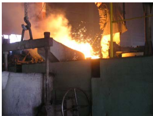
除滓作業の様子（通常時）
