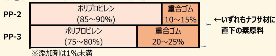
【図1】代表的な樹脂材の主原料構成
